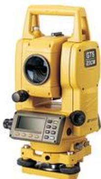
**ESTAÇÃO TOTAL** – Estação total eletrônica TOPCON, modelo GTS-105N padrão e modelo GPT 3205 NW de medição sem prisma. Leitura direta de 1" e precisão de 5", alcance de 2.000 m, precisão linear de 2 mm + 2 ppm, coletor de dados interno com memória para 12.000 pontos com todos atributos ou 24.000 pontos de coordenadas (N, E).
