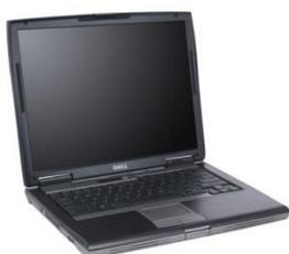
**NOTEBOOK** – Computador portátil destinado ao uso campo/escritório uma vez que pode ser facilmente transportado. Sua tecnologia e portas de comunicação Serial/USB possibilitam a conexão com vasta linha de equipamentos de Topografia.
